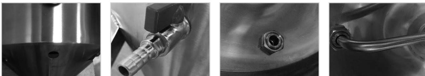
Sigillare la valvola del filtro con un po' di nastro PTFE (non incluso), avvitare la valvola del filtro sul tubo del filtro, come mostrato nell'immagine. Suggerimento: assicurarsi che il nastro PTFE sia sufficientemente aderente, in modo da prevenire perdite.
