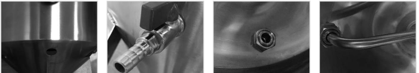
Vede a válvula do filtro com fita de PTFE (não incluída); aparafuse a válvula do filtro no tubo do filtro conforme ilustrado. Dica: certifique-se de que a fita de PTFE está suficientemente vedada para evitar fugas.
