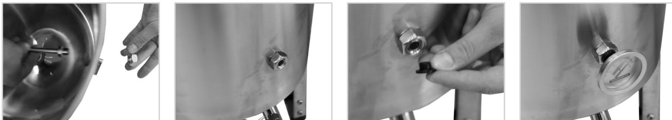
Plaats de bolkraan in de daartoe bestemde opening op de conische bodem en draai ze vast met een M12-moer. De opening bevindt zich aan de voorkant van het gistingsvat op de conische bodem, zoals op de foto wordt getoond. Tip: plaats de roteerbare hevelarm in de inlaat van de klep, zoals op de foto wordt getoond. De richting van de hevelarm kan worden aangepast door de bolkraan tijdens de vergisting te draaien.
