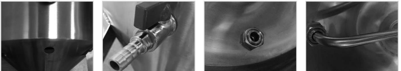
Forsegle silventilen med litt gjengetape (medfølger ikke), og skru deretter silventilen på røret som vist. Tips: Sørg for at gjengetapen tetter skikkelig for å hindre lekkasje.
