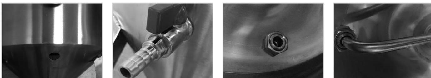
Forsegl filterventilen med PTFE-tape (medfølger ikke), skru filterventilen på filterrøret som vist. Tip: Sørg for, at PTFE-tapen forsegler tilstrækkeligt, så det kan forhindre lækage.
