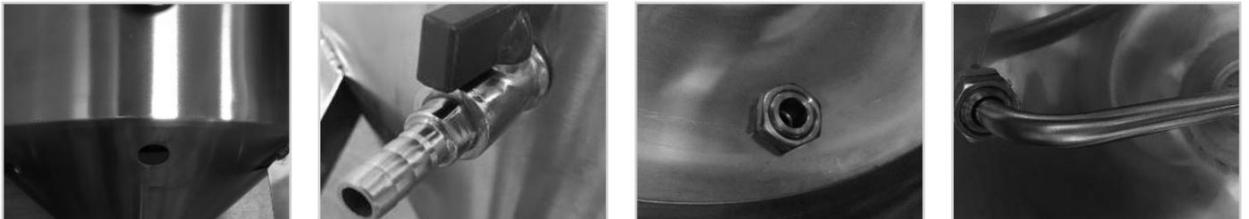
Siebventil mit etwas Gewindedichtband abdichten (nicht im Lieferumfang enthalten), Siebventil wie abgebildet auf die Siebleitung schrauben. Tipp: Gewindedichtband auf seine Dichtigkeit überprüfen, um das Austreten von Flüssigkeit zu vermeiden.
