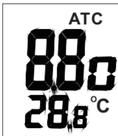
4. Druk op “ HOLD ” om de huidige uitlezing vast te houden. Op het LCD-scherm verschijnt er “ H ” en het stipje knippert niet. Druk opnieuw op “ HOLD ” om de HOLD-functie te verlaten.
