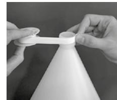
**Paso 3: Fije el extremo firme de la válvula de unión al fermentador cónico.**
