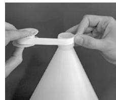
**Passo 3: Una a extremidade sólida da válvula de união ao fermentador cónico.**
